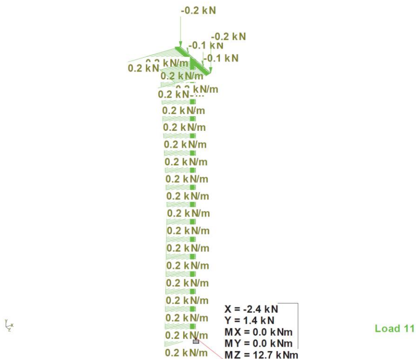
Slika 2.8.1.-11 Reakcije za kombinaciju opterećenja B1
