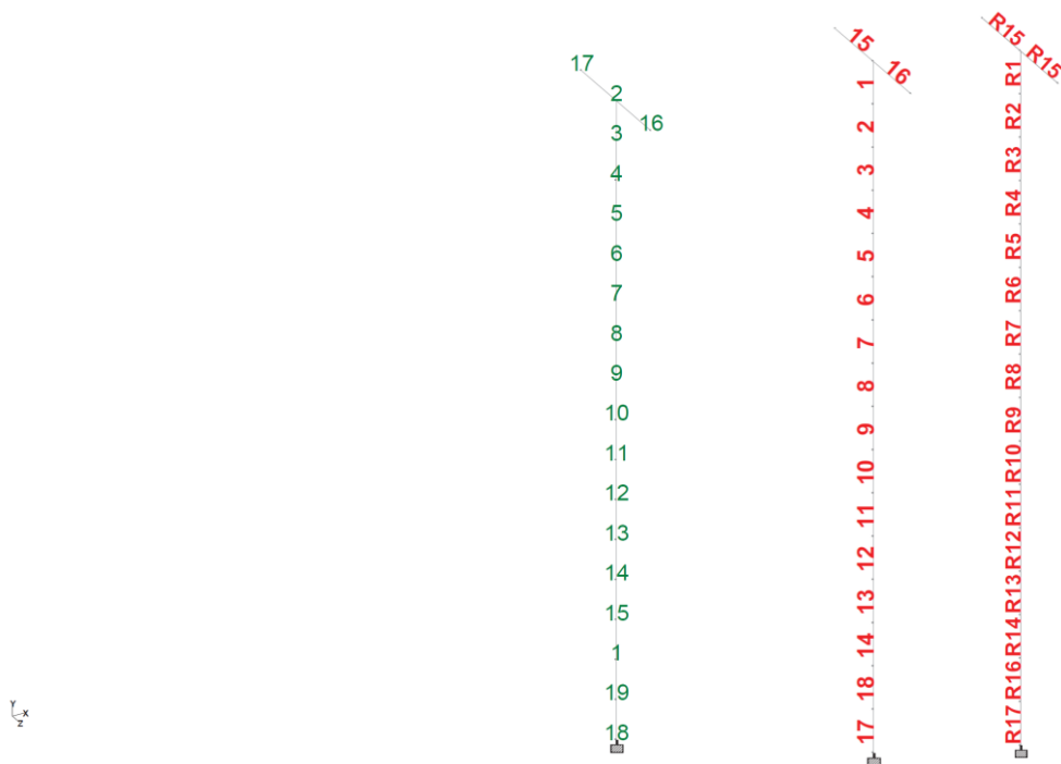
Slika 2.8.1.-2 Oznaka čvorova (lijevo), elemenata (sredina) i svojstava (desno)
